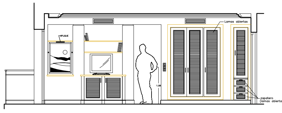
SECCION S1-S1, (CON FRENTE DE CARPINTERIA)
